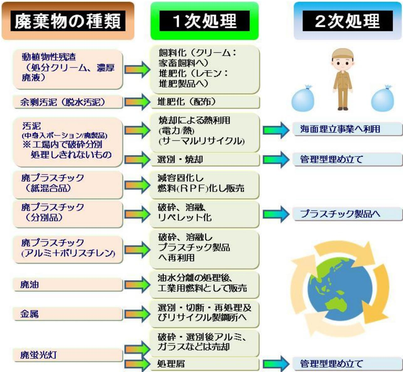
特に、生産中の品種切り替え時や、包装材料の継ぎ目などで発生する中身入ポーションを、できるだけ分別し、排出後の処理が資源の有効利用につながるよう、その多くの部分を敷地内で **破碎・分別** してから、それぞれの再生・再利用できる処理業者へ排出しています。
