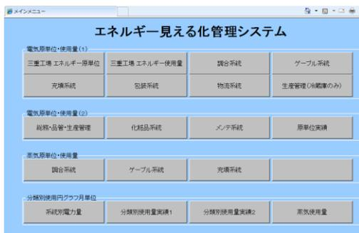
弊社三重工場内での省エネ活動の一環として、各部門、工程別の電気、蒸気の使用量データをリアルタイムに抽出し、過去データと合わせてグラフ化し、比較も容易にできるシステムを構築いたしました。今後の省エネ活動に活かして参りたいと考えております。
